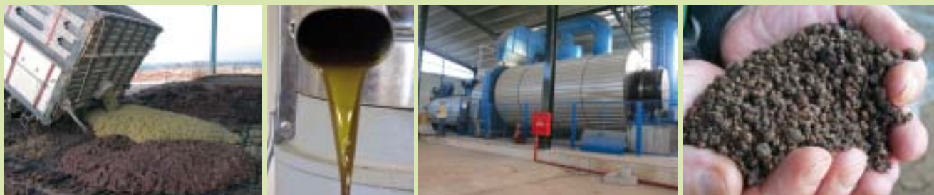
Anlieferung des Tresters, Zentrifuge, Trocknungsanlage, Tresterpellets zum Heizen
